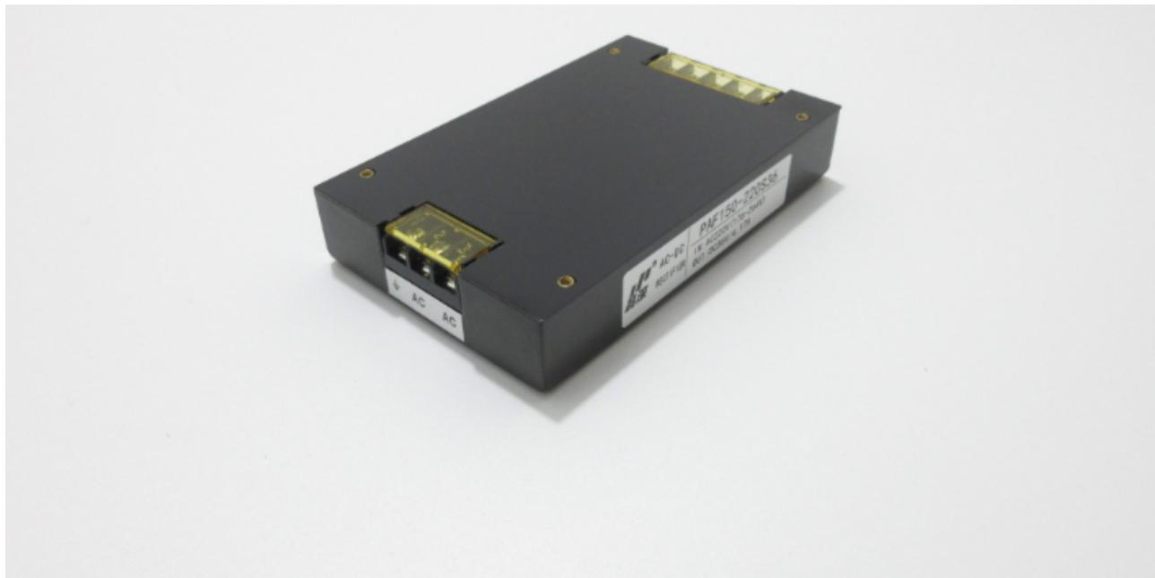
目前实现直流稳压的线路有两大类型，一类是传统的以变压器为降压中心、附加稳压线路的线性电源，一类是现在流行的以工作于开关状态的电子电路构成的开关电源。这两种类型的电源各有自己的优、缺点。线性电源的优点是纹波容易控制，线路简单，易于维修。缺点是体积笨重，需要用到变压器和大容量电容，转换效率不高。开关电源的优点是体积小、重量轻、转换效率可以做得比较高、不需要使用昂贵的变压器和大容量电容。缺点是电路结构比较复杂，维修困难，不可避免地存在开关频率干扰，纹波比较难控制。目前随着开关电源技术的成熟和金属铜价的节节攀升（制作变压器需要耗费大量的铜线），传统线性电源的成本优势越来越小，大电流输出的开关电源的价格优势越来越明显。
